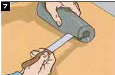
Das Reduzierstück kann an der Längsnaht und mit den Stößen der angrenzenden Schläuche verklebt werden.
