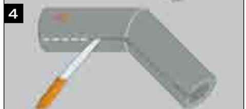
Nach der Montage auf dem Rohr alle Nähte verkleben.
