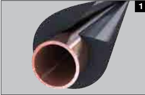
Die Verwendung der selbstklebenden KAIFLEX Schläuche empfiehlt sich besonders bei bereits installierten Leitungen, bei denen eine Vorisolierung nicht möglich ist. Die Vorteile des SK-Schlauches liegen in der einfachen Handhabung und der Zeitersparnis infolge kürzerer Montagezeiten. Auch die Isolierung von Bögen mit selbstklebenden KAIFLEX Schläuchen ist problemlos.
