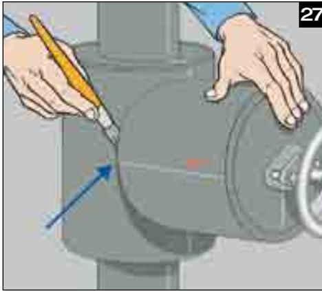
Mit Pinsel und KAIFLEX Kleber beide Bauteile verbinden.
