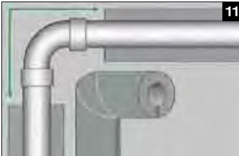
Wurden die geraden Rohrlängen bereits isoliert, muss der Winkel genau angepasst werden.
