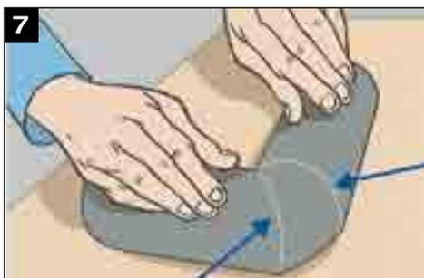
Nach dem Ablüften des Klebers kann der Winkel in der Innenseite längs geschlitzt werden.
