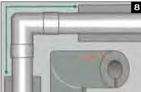
Wurden die geraden Rohrlängen bereits isoliert, muss der Winkel genau angepasst werden.
