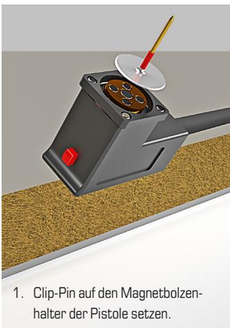
1. Clip-Pin auf den Magnetbolzenhalter der Pistole setzen.
